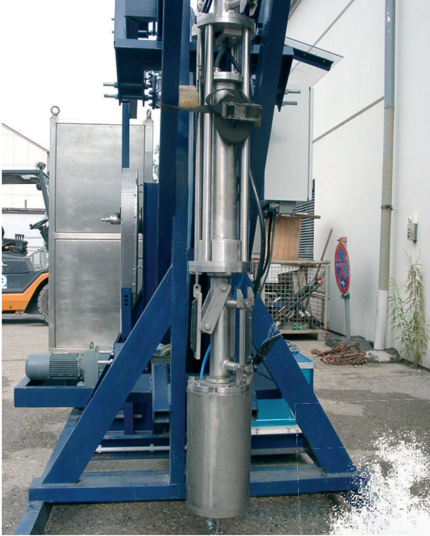
Spezialanlage für die Perforation von Filterrohren („Wasserschneiden“)
